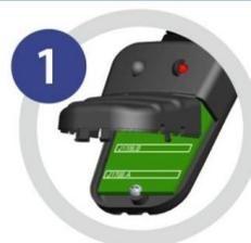
2. Coloque os fios CAN HIGH e CAN LOW na interface CAN TIPO 1.
