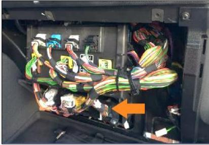
Remova a cobertura do painel de instrumentos inferior. Os fios CAN encontram-se localizados perto da ECU inferior. O conector azul pode ser encontrado no lado direito da ECU.
