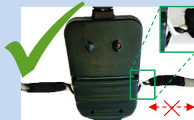
Fios CAN firmemente torcidos contra a interface CAN TIPO 1 => Os fios CAN já não se podem movimentar na interface CAN TIPO 1.
